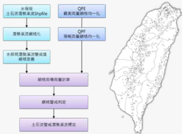
圖1 網格雨量預警土石流技術流程
