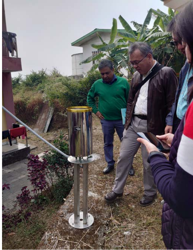
圖 2：雨量監測儀
