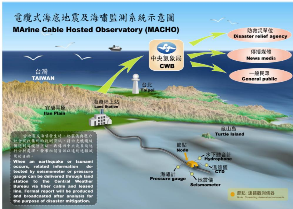
圖 1 中央氣象局「台灣東部海域電纜式海底地震儀及海洋物理觀測系統」示意圖
